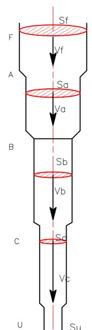
Il sistema si basa sul teorema di Venturi A parità di portata e pressione, la variazione di sezione di un condotto determina un aumento di velocità del flusso: Vf\*Sf = Va\*Sa = Vb\*Sb = Vc\*Sc = Vu\*Su
